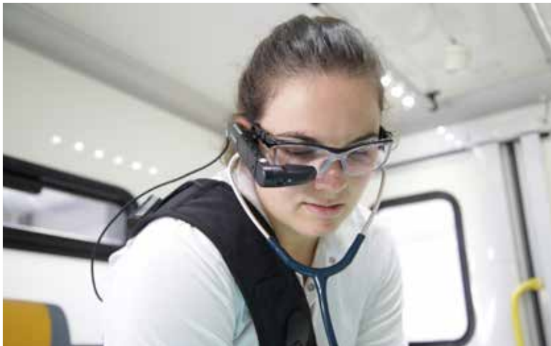
Les lunettes permettent au médecin régulateur de visualiser une intervention à distance et de guider l'opérateur.
